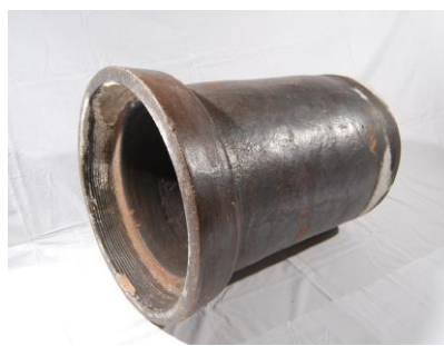
導水路に用いられた土管
