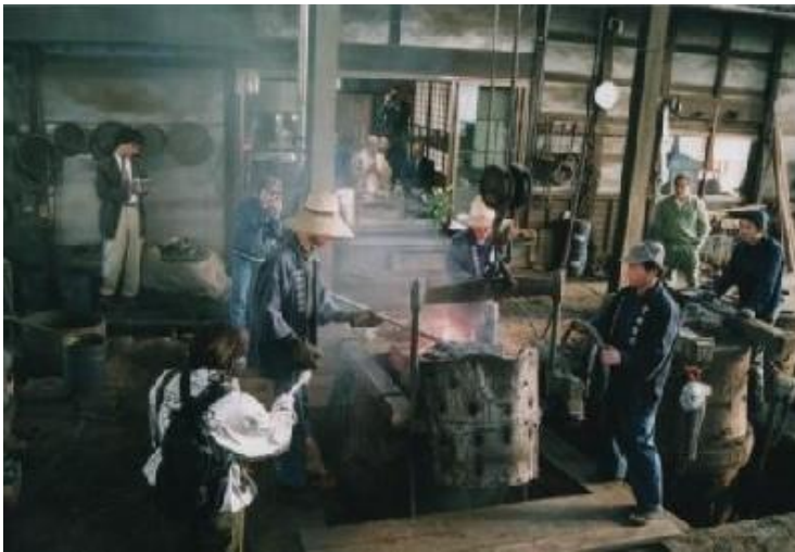
左上：地元の粘土で作った鑄型、中央上：溶鋳炉に材料を入れて溶かす
