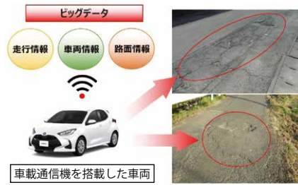
道路状況調査の新技術
