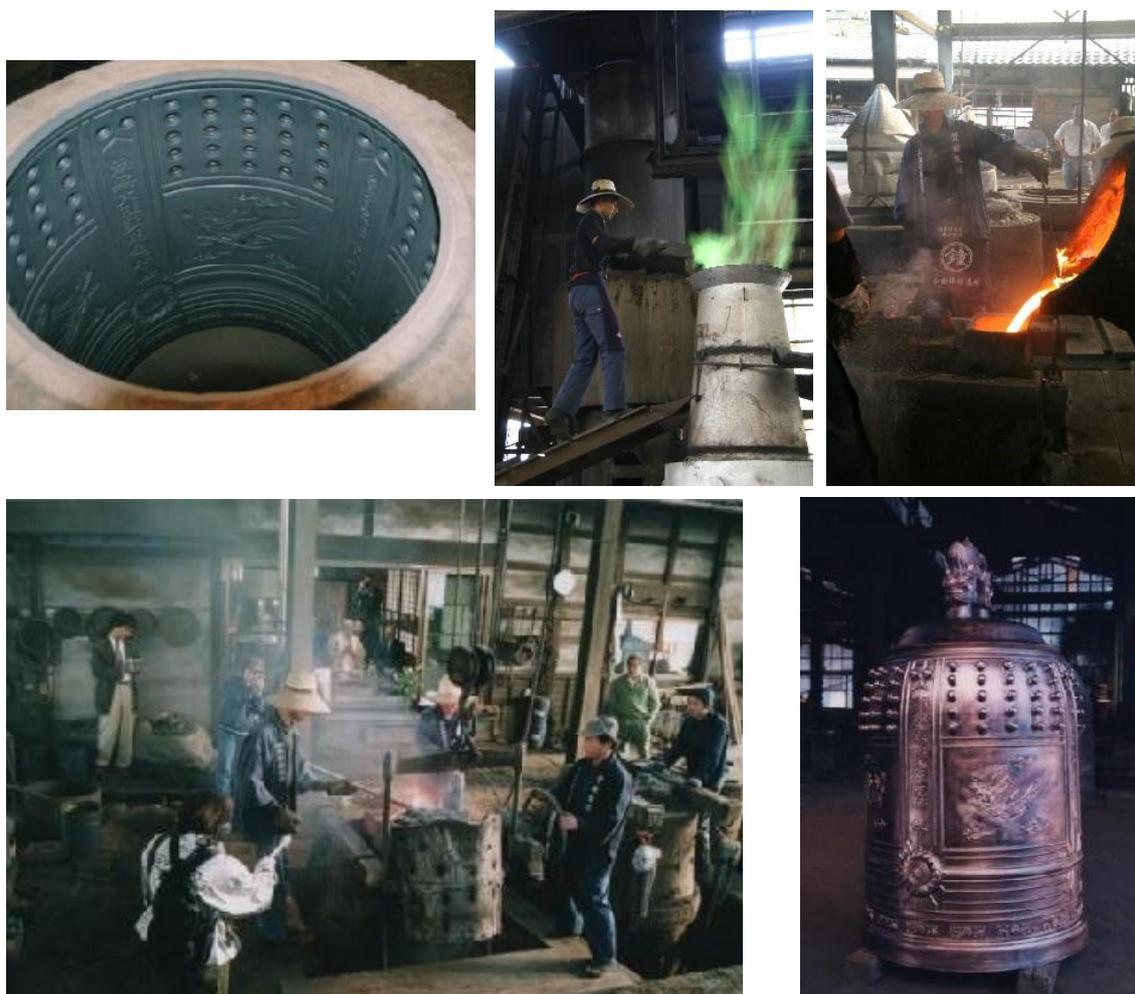
左上：地元の粘土で作った鑄型、中央上：溶鋸炉に材料を入れて溶かす
