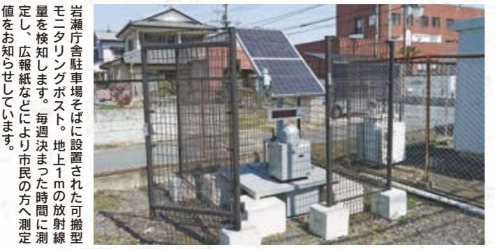
岩瀬町舍駐車場そばに設置された可搬型モニタリングポスト。地上1mの放射線量を検知します。毎週決まった時間に測定し、広報紙などにより市民の方へ測定値をお知らせしています。
