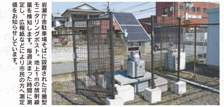
岩瀬町舍駐車場そばに設置された可搬型モニタリングポスト。地上1mの放射線量を検知します。毎週決まった時間に測定し、広報紙などにより市民の方へ測定値をお知らせしています。
