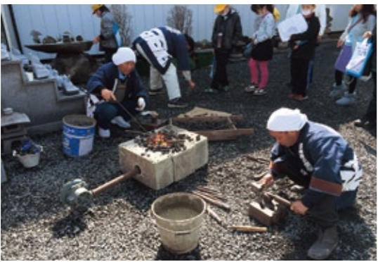
真っ赤に焼けた鉄をハンマーでたたき、水の中に入れては冷ます作業をする真壁石工技能士会の皆さん
