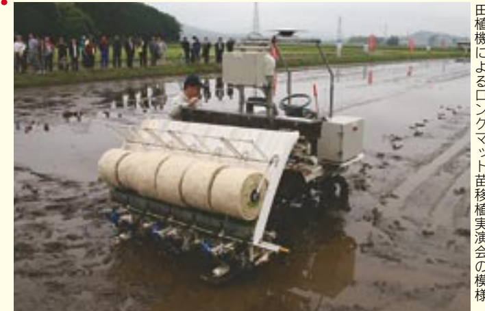
GPS（全地球測位システム）を利用した無人田植機によるロングマット苗移植実演会の模様
