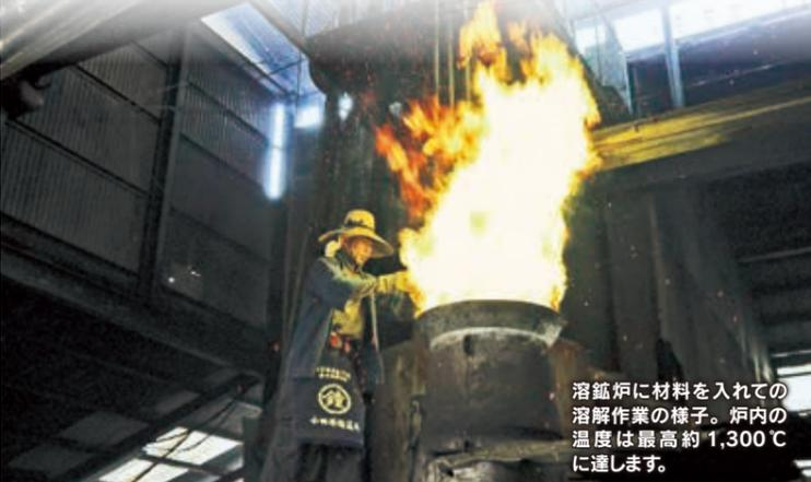
溶鑄炉に材料を入れての溶解作業の様子。炉内の温度は最高約1,300℃に達します。
