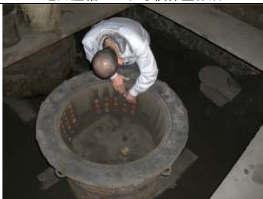
素焼の模様を粘土の型に埋め込む
